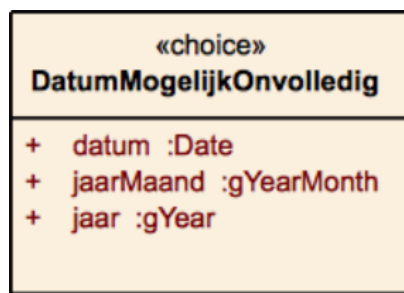
Afbeelding 1. UML class-diagram voor het complex type DatumMogelijkOnvolledig
